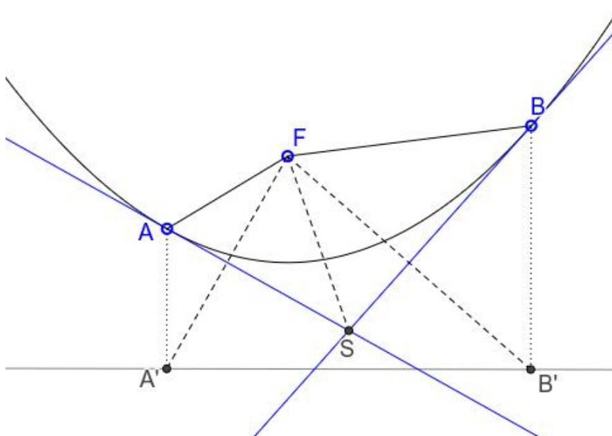
Per la proprietà di “riflessione” della parabola, che i raggi paralleli al suo asse si riflettono nel fuoco, si vede facilmente che la tangente in  $A$  è bisettrice dell'angolo  $\widehat{FAA'}$  ed essendo  $AF = AA'$ , segue che è perpendicolare al segmento  $FA'$ . Da ciò otteniamo che  $FS = SA'$  e ripetendo lo stesso argomento per il punto  $B$ , anche  $FS = SB'$ , cioè i punti  $F$ ,  $A'$  e  $B'$  stanno su un cerchio di centro  $S$ .
